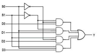
6. Considere o diagrama lógico da figura. i) Indique a função realizada pelo circuito; ii) Determine a forma de onda da saída Y em resposta às formas de onda do diagrama temporal.
