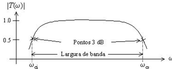
Fig. 2: Resposta espectral de um circuito. Largura de banda. Pontos -3 dB.
