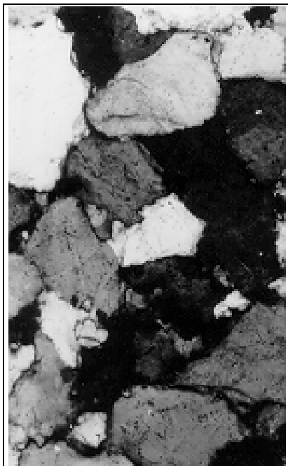
Figura 4 - Desenvolvimento heterogéneo de microfracturas intragranulares. Amostra B3, NX, 1,2 cm = 50 \mu\text{m} .
