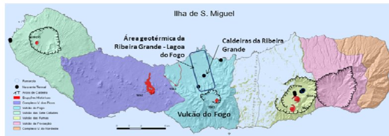
Figura 1. Localização das Caldeiras da Ribeira Grande, no Vulcão do Fogo, Ilha de S. Miguel; representação da área geotérmica da Ribeira Grande – Lagoa do fogo que delimita o sistema hidrotermal de alta entalpia no flanco norte do vulcão (base geológica de Nunes, 2004).
