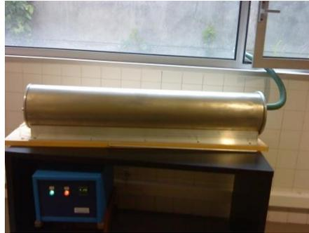
Figura 4.4: Forno magneticamente blindado do IDL.
