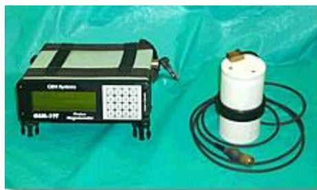
Figura 1.6 - Magnetómetro de Protões produzido pela GEM
