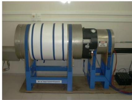
Figura 1.8 - Magnetómetro criogénico de marca 2G-entreprises
