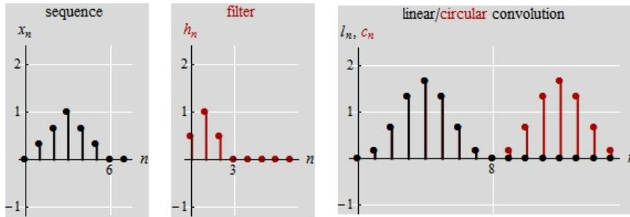
Fig. 2: Igualdade das convoluções circular e linear quando os sinais são previamente 'enchidos' com zeros até à dimensão final  $N_H + N_X - 1$ . Neste exemplo  $N_X = 6$  e  $N_H = 3$ . Logo,  $N = N_X + N_H - 1 = 8$ . Logo, note que as convoluções circular e linear são iguais para  $0 \leq n < 8$  (como se disse, apenas nos interessa aqui o resultado da convolução circular para  $0 \leq n < N$ ).
